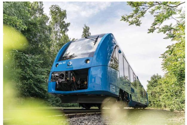
Mit Wasserstoff betriebener Brennstoffzellenzug „Coradia iLint“
