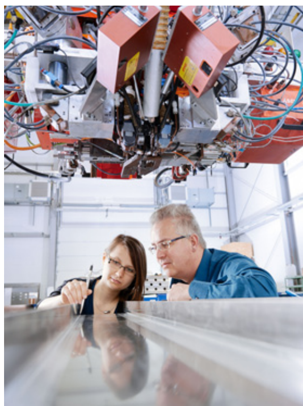
Materialforscher am Helmholtz-Zentrum Geesthacht überprüfen eine mit dem Laser geschweißte Naht für den Flugzeugbau
